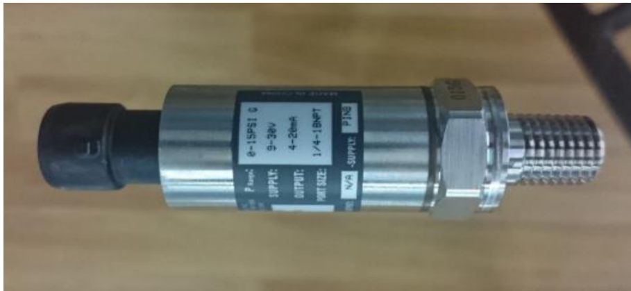
Figura 5.2: Transductor de presión U5300 (Hernández, 2019).
